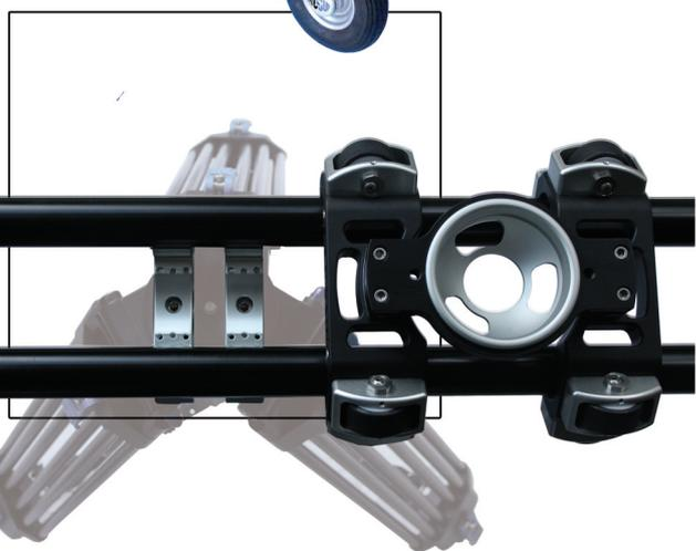
Слайдер Tango Roller правда называют слайдером хотя двигается на специально разработанных резиновых роликах скорее как мини-тележка. Он перемещается значительно плавнее и прежде всего тише чем обычные слайдеры. Продливаемые без ограничений рельсы Tango предлагаются длиной 1м, 1,2 м и 1,5 м. У всех рельсах есть на нижней части отверстие с резьбой 3/8 дюйма для крепления на (видео-) штатив.
