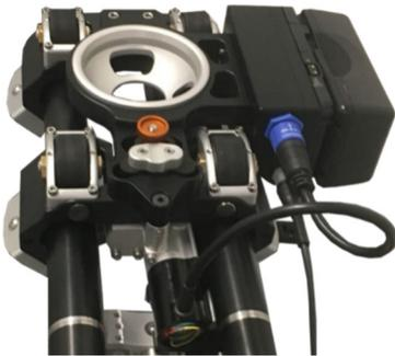
2. Bevor Sie den TED Tango in die Schiene einsetzen, beachten Sie die Lage der Antriebseinheit. Diese muss immer auf der Seite der Zahnstange sein und der Motor sollte leicht im Winkel zur Schale stehen. Nur in dieser Position berührt er nicht die Zähne beim Einsetzen. Trifft das nicht zu, müssen Sie den TED Tango u.U. noch mal umdrehen.
