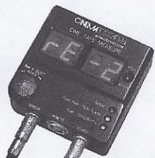
Abb. 4: Im »r E«-Untermenü kann der Meßwinkel des Sensors verändert werden.
